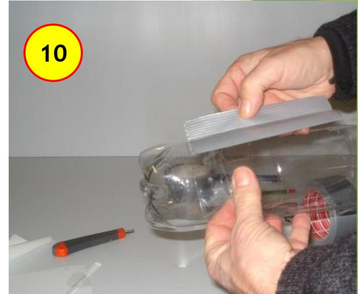
Coller un segment de ruban adhésif en biais sur les coins de l'ouverture opposés à la charnière. Ce dispositif évite au volet de basculer à l'intérieur de la boîte.
